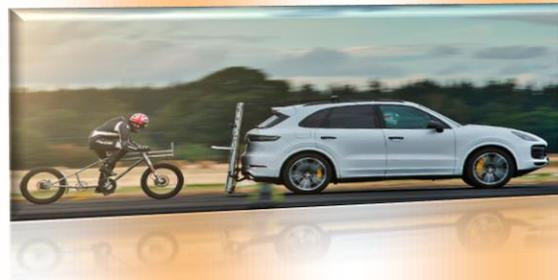
El coche un Porsche Cayenne Turbo, con motor **4.0 litros V8 biturbo** de **550 CV** y 770 Nm, y en este caso equipado, eso sí, con una estructura a modo **de pantalla aerodinámica para ayudar todavía más al ciclista**.
